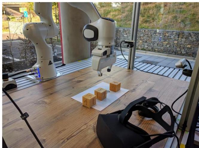
**Abbildung 21:** ferngesteuerter Roboterarm.
