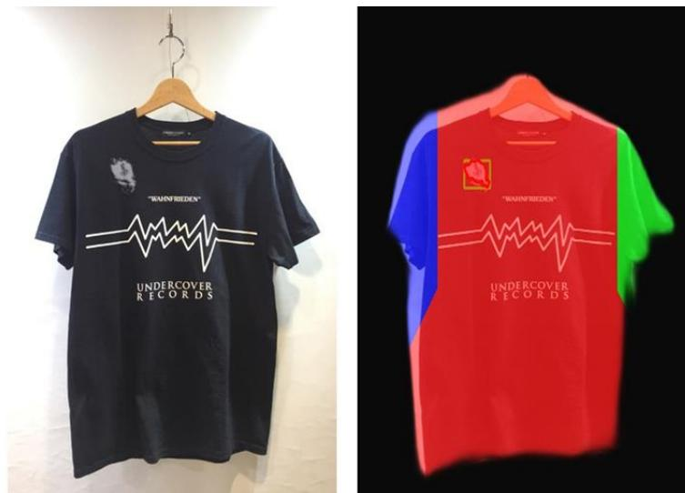
**Abbildung 5:** Das in PreQA entwickelte System zur Fehlererkennung nutzt Bildverarbeitung und KI um Fehler, wie etwa Flecken, automatisiert zu identifizieren und einzuordnen.
